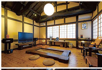
田の字型に住切られていた壁の梁をひとつにつなげ、現代のライフスタイルに合う大空間を創出。床には厚さ3cmの無垢材を入れて断熱性を確保。また、在中段の梁裏様に高い吹き抜けがあるからこそ大きな照明もパワースタイルが取り、現代風の照明器具が併用可能。
